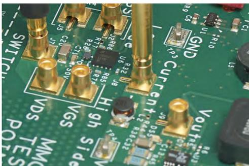
IsoVu-Tastkopfspitzen verfügen über eine Reihe von Anschlüssen und Zubehörteilen, die hohe Leistung und Zugänglichkeit bieten. Die Tastköpfe können direkt an MMCX-Steckverbinder angeschlossen
