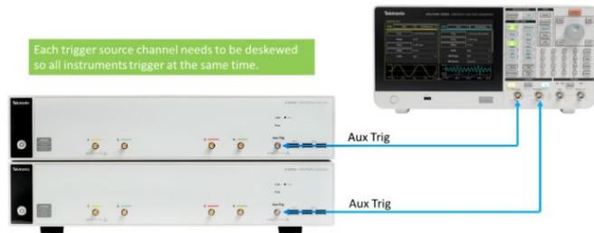
Synchronisieren Sie mehrere Instrumentenkanäle innerhalb von 200 ps mithilfe eines manuellen Versatzausgleichs und dem Hilfstrigger-Eingang
