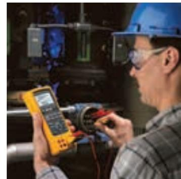
Einfache Kalibrierung von Temperaturtransmittern mit den Kalibratoren Fluke 725 und 726
