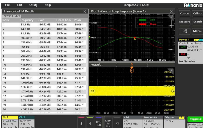
Frequenz-Antwortanalyse auf der MSO Serie 2
