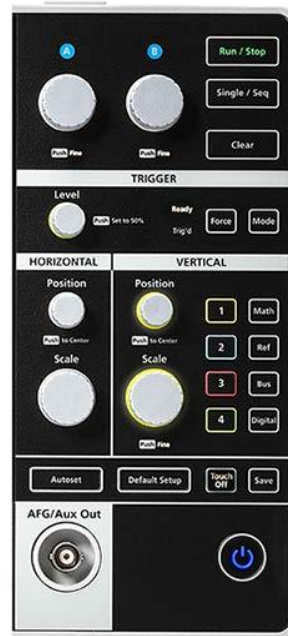
Vereinfachte und intuitive Frontplatte mit farbkodierten LEDs
