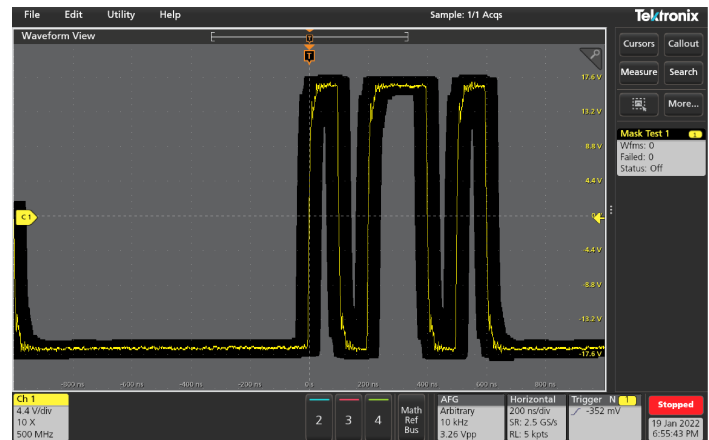
Grenzmaskentest basierend auf einem digitalen Referenzsignal
