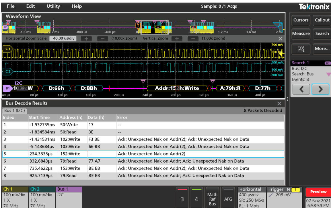
Eine Bus-Signalform liefert zeitkorrelierte dekodierte Pakete, während die Bus-Dekodierungstabelle alle Pakete der gesamten Erfassung anzeigt. Die Suche kann zur Navigation verwendet werden.
